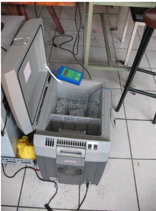
Fotografía N° 3. Ensayo de controladores a baja temperatura (fuente, Laboratorio de Energía Solar –UNI)
