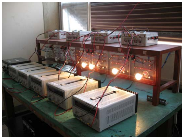
Fotografía N° 2. Ensayo de baterías, proceso de descarga (fuente, Laboratorio de Energía Solar –UNI)
