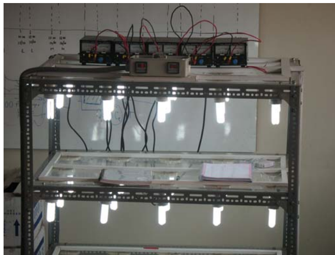
Fotografía N° 5. Ensayo de lámparas, ciclado (fuente, Laboratorio de Energía Solar –UNI)
